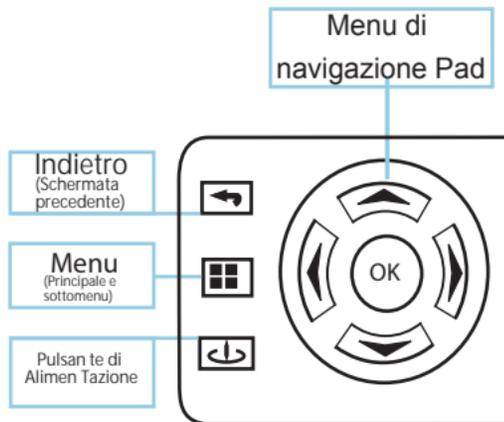
Il principale Menu di navigazione sulle funzioni remote esattamente come il pad direzionale sull'unità P3X.
